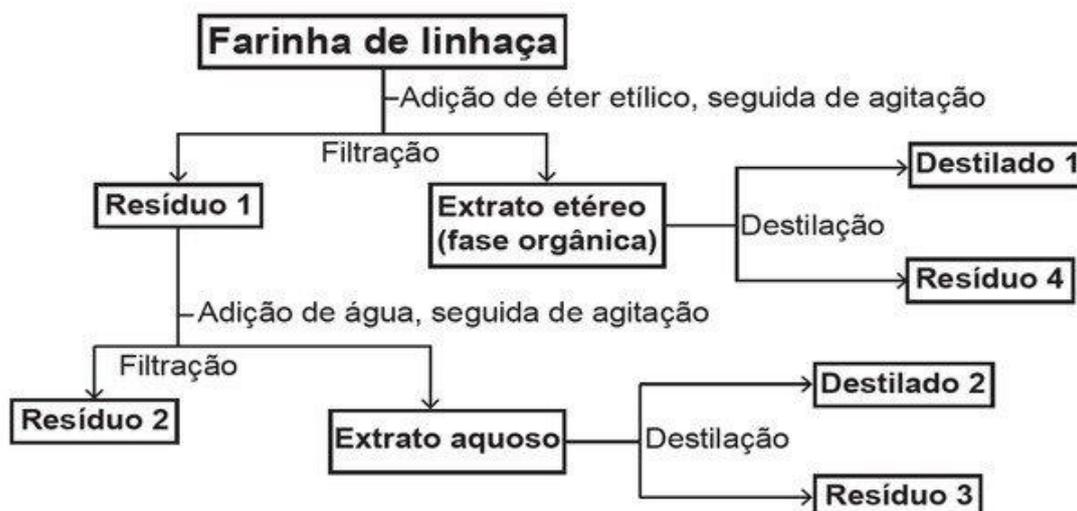
Considere o esquema, que resume um processo de separação dos componentes principais da farinha de linhaça dourada.
